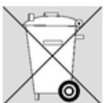
Entsorgen Sie das Gerät im Rahmen der endgültigen Stillsetzung bzw. Teile davon umweltgerecht und sortenrein (Metall zum jeweiligen Metallschrott, Kunststoff zum Kunststoffmüll, etc. – nicht mit dem Hausmüll entsorgen)!
