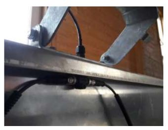
Stecken Sie die beiden Wiegesignalkabel rechts und links an den Verteiler an.
