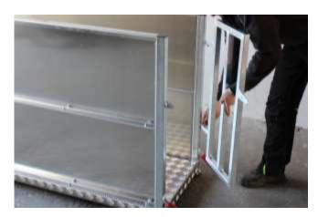
Montieren Sie die Türen jeweils mit der Kerbe beim Türanschlag nach unten.
