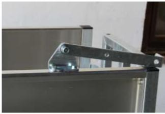
Befestigen Sie den Hebel außen am Montagewinkel. Der kurze Teil des Hebels muss nach innenn zeigen. Stecken Sie die Linsenkopfschraube von innen nach außen.
