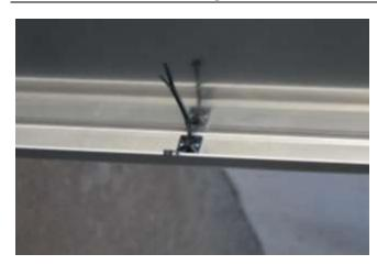
Ziehen Sie je einen Kabelbinder durch die Lasche der selbstklebenden Kabelhalterungen.
