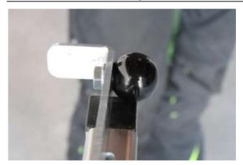
Montieren Sie die Kugel außen am Hebel.
