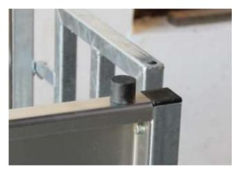
Montieren Sie den Gummipuffer an der linken Seitenwand It. Abbildung.
