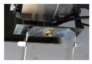
Verbinden Sie den Bügel der Anzeige mit dem Haltebügel an der Waage mit der Verschraubung.
