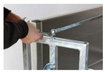
Befestigen Sie die Stange mit einem Kugelgelenk in der mittigen Bohrung an der vorderen Tür.
