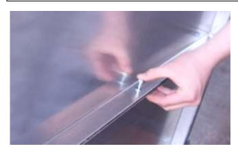
Montieren Sie die jeweils 4 Schrauben pro Seite für die Verschraubung der unteren mit den oberen Seitenteilen.
