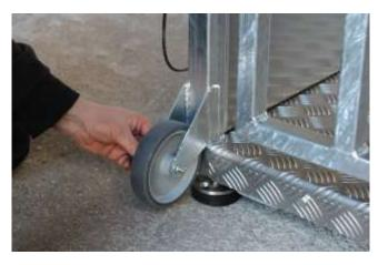
Montieren Sie die beiden Räder an der Vorderseite der Waage. Zwischen Rad und Befestigungslasche ist je eine Scheibe vorgesehen. Die Räder haben eine gelagerte Innenbuchse, die Schrauben können daher festgezogen werden.
