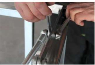
Befestigen Sie die Stange mit dem zweiten Kugelgelenk in der Bohrung am Betätigungshebel.
