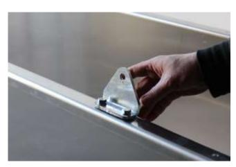
Befestigen Sie den Montagewinkel an der linken Seite der Waage mit 2 M8 Schrauben. Der stehende Teil muss nach innen zeigen.
