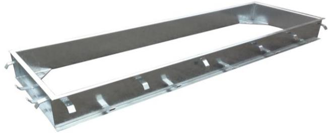
Der Rahmen hat eine Höhe von 298 mm. Bleiben Sie mit dem Unterbau ca. 10 cm unter dem Einbaurahmen, damit der Rahmen und vor allem die Aufstandsplatten in den Ecken mit Beton unterfüllt werden können.
