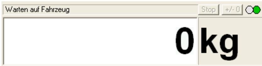
Rechts oben im Hauptfenster wird laufend das aktuelle Gewicht, mit dem die Waage belastet ist, angezeigt. Im Wiegemodus ist dieser Wert auch auf der Zusatzanzeige ersichtlich. Im Wiegemodus können auch zusätzliche Informationen in diesem Feld, und damit auch auf der Zusatzanzeige ausgegeben werden, um dem Fahrer Anweisungen zu geben. Siehe „Informationen auf der Zusatzanzeige“.
