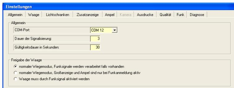
Der COM-Port muss auf die Nummer der COM-Schnittstelle verweisen, an der das serielle Kabel des Funkempfängers angeschlossen ist.
